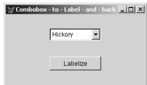
Рис. 2. Пример формы, показывающий нормальную (т. е. открытую как на чтение, так и на запись) combo box.
